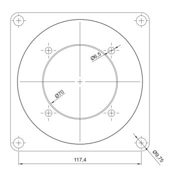
Assemblaggio lato collettore: 4 x viti DIN 6921 M8 x 25 Manifold side assembly: 4 x screws DIN 6921 M8 x 25 Assemblaggio lato motore: 4 x viti DIN 5931 M6 x 16 Motorside assembly: 4 x screws DIN 5931 M6 x 16
